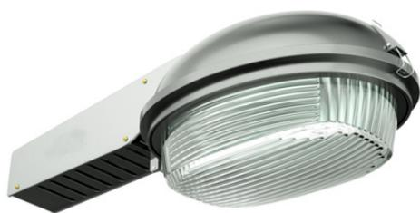
Luminária pública fechada, com refrator prismático em policarbonato corpo refletor estampado em chapa de alumínio anodizado. Aro, tampa e alojamento para equipamento elétrico em liga de alumínio fundido. Encaixe em ponta de braço 48 ou 60,3mm.
