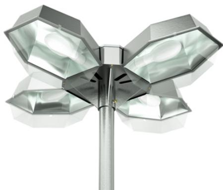
Luminária fechada, corpo e alojamento central em liga de alumínio fundido, corpo refletor pintado internamente na cor branca, para montagem até 4 pétalas. Encaixe para tubo Ø60,3mm.
