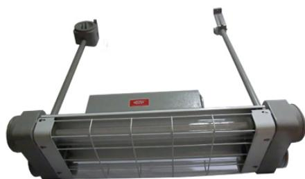
Aparelho para iluminação com cabeceiras e corpo fabricado em liga de alumínio fundido, fixação pendente, tubos para proteção da lâmpadas fluorescentes, refletores em chapa de aço, grade de proteção galvanizada. Fornecido com um furo rosqueado em 3/4" BSP ou NPT.
