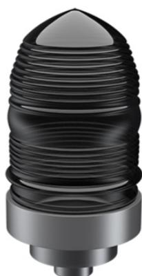
Aparelho para sinalização em liga de alumínio fundido, para uma ou duas lâmpadas incandescentes 60w. Globo de vidro ou macrolon nas cores vermelho, verde ou âmbar, (a pedido fornecido com vidro prismático), vedações de borracha resistente ao calor e ao tempo. Fornecido com uma entrada rosqueada em 3/4 " BSP ou NPT.
