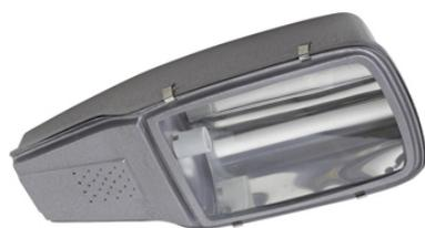
Luminária pública fechada, com montagem para até 06 pétalas, através de núcleo, ou fixação em ponta de braço corpo, aro tampa e alojamento para equipamento elétrico em liga de alumínio fundido. Fixação por meio de suporte central para topo de poste de 0 60,3mm ou 114mm Externo. Refletor em alumínio estampado e
