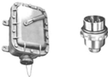
Tomada bloqueada, fabricada em alumínio fundido, equipada com disjuntor trifásico de proteção térmica e magnética de até 100A, 480V. Circuito: 3 fios + terra, comando externo através de alavanca frontal. Tampa rosca para proteção da tomada, orelha de fixação. a pedido poderá ser fornecida com plug correspondente.
