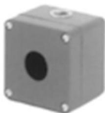
Botoeiras fabricadas em alumínio fundido e acabamento pintado em epoxi na cor laranja munsell, para montagem de botões de comando e/ou luz piloto, sendo as furações na tampa p/ botoes 22mm ou 30,5mm em diversas combinações de entradas rosqueadas 1/2 ou 3/4 BSP.
