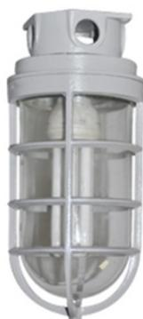
Aparelho para iluminação fabricado em liga de alumínio fundido, grade reforçada, fixação plafonier, globo de vidro alcalino ou borossilicato, soquete de porcelana, vedações de borracha resistente ao calor e ao tempo. Fornecido com quatro furos rosqueados de 3/4" BSP ou NPT.
