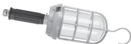
Aparelho para iluminação fabricado em liga de alumínio fundido, grade reforçada, para uso portátil, globo de vidro alcalino ou borossilicato, soquete de porcelana, vedações de borraça resistente ao calor e ao tempo.
