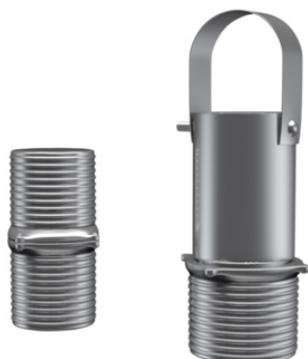
Suspensão em aço galvanizado, com bucha de redução  $\varnothing$  3/4" x 3/8", para fixação tipo plafonier de aparelhos de iluminação fluorescente em tubos de 3/4".
