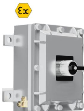
Disjuntor de proteção térmica e magnética, com tipo de proteção à prova de explosão Ex d IIB, zonas 1 ou 2 - grupos IIA ou IIB, grau de proteção IP66, corpo e tampa em liga de alumínio fundido copper-free, acabamento epóxi cinza claro, até 220V, montagem de até 08 interruptores, entradas rosqueadas BSP ou NPT. CERTIFICADO DE CONFORMIDADE Nº BVC09.9928
