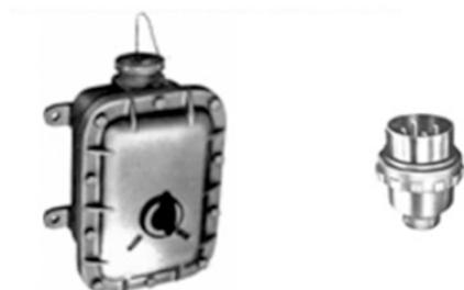
Tomada bloqueada, Blindada em caixa, fabricada em alumínio fundido, equipada com chave tripolar tipo pacco "liga-desliga" de até 100A, 500V. Circuito: 3 fios + terra, comando externo através de alavanca frontal. Tampa rosca para proteção da tomada, orelha de fixação. a pedido poderá ser fornecida com plug correspondente.
