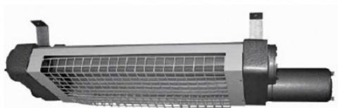
Aparelho para iluminação blindado, fixação no teto, para 1 2 ou 4 lâmpadas fluorescentes, de 20W ou 40W. Refletor em chapa de aço, compartilhamento para reator na cadeira em liga de alumínio fundido. Compartimento para proteção da lâmpadas. Rede de proteção esmaltado na cor branca. Entrada rosqueada de 3/4" Gás ou NPT.
