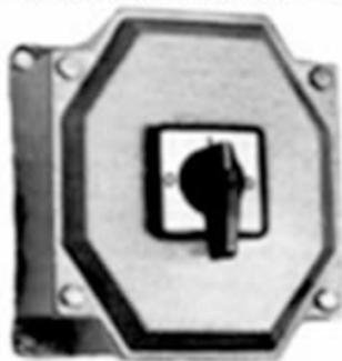
Chave rotativa tipo "pacco" tripolar para serviço pesado, ligamento e desligamento rápido a plena carga. Comando externo através de alavanca frontal. Disponível de 15A a 100A 500V, com ou sem fusíveis, tipo diazed. ( Retardado ).
