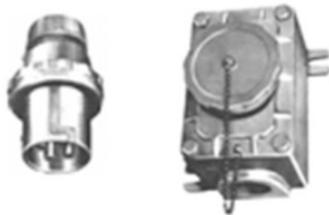
Tomadas e plugs para 15, 30 e 60 A, até 4 pólos e 380V. caixa e tampa fundidos em liga de alumínio, tampa com mola ou rosqueada. capa de plug de alumínio fundido.
