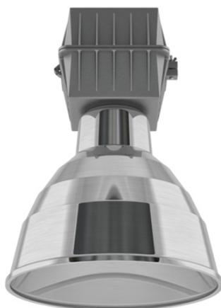
Luminária industrial, corpo repuxado em chapa de alumínio anodizado, alojamento incorporado em liga de alumínio fundido, com aletas para dissipação do calor, a pedido com visor plano de cristal temperado ou grande, soquete E-27 ou E-40.
