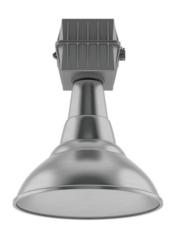
Luminária industrial, corpo repuxado em chapa de alumínio anodizado, alojamento incorporado em liga de alumínio fundido, com aletas para dissipação do calor, a pedido com visor plano de cristal temperado ou grande, soquete E-27 ou E-40.
