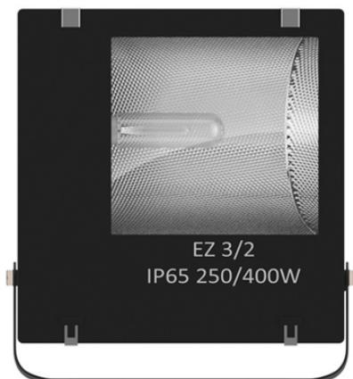
Projektor fechado, corpo em liga de alumínio injetado, refletor em chapa de alumínio, com alojamento integrado para reator, visor em vidro plano temperado incolor, suporte de fixação galvanizado a fogo.
