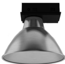
Luminária industrial, corpo repuxado em chapa de alumínio anodizado, alojamento em chapa de aço com tratamento epóxi na cor preta, a pedido com visor plano de cristal temperado ou grande, soquete E-27 ou E-40. Lâmpada vapor mercúrio, metálico ou sódio 250/400W
