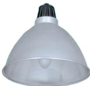
Luminária Industrial, corpo repuxado em chapa de alumínio anodizado, soqueteira em liga de alumínio fundido com aletas para dissipação do calor, a pedido com visor plano de cristal temperado ou grade, soquete E-27 ou E-40.
