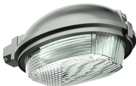
Luminária pública fechada, corpo, aro e suporte de fixação em liga de alumínio fundido, refrator prismático em policarbonato e refletor estampado em chapa de alumínio anodizado. Encaixe em ponta de braço 48 ou 60,3mm.
